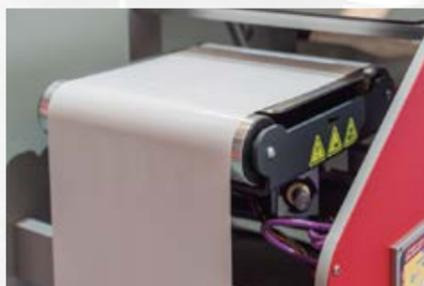
• BST Web Edge. Sistema de guía con sensor de borde ultrasónico para garantizar una alineación perfecta de los rollos.
