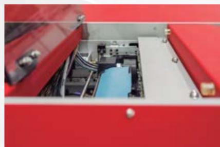
• Cabezal Sirius Memjet de inyección de tinta de paso único .
