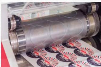
• Cilindro de corte magnético semirrotativo velocidad 9 a 18 m / minuto.
